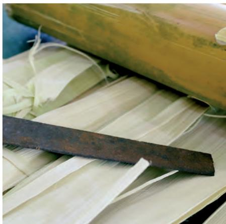
Une fois lissées, les fines lamelles de bambou sont trempées dans l'eau de mer pendant deux à quatre semaines afin de pouvoir les travailler plus facilement
